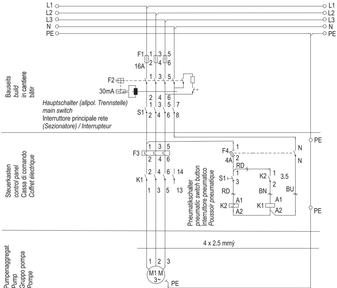
Sicherung FI Schalter 30 mA, Hauptschalter sind bauseits nach den gültigen DIN VDE Bestimmungen anzuordnen
