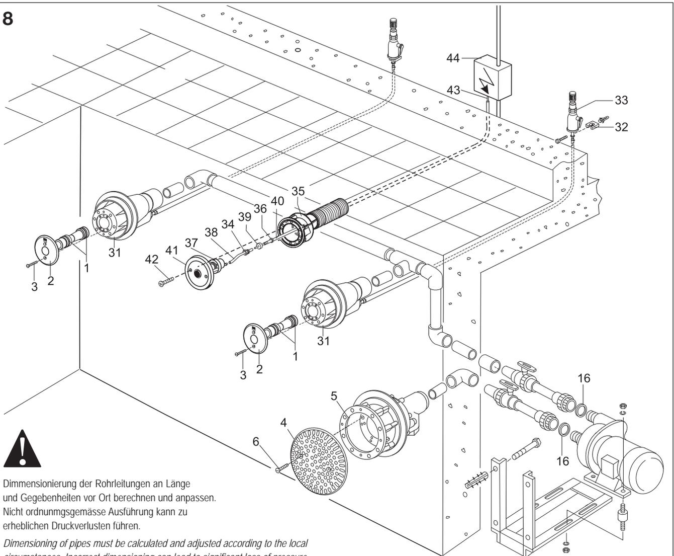
Dimensionierung der Rohrleitungen an Länge und Gegebenheiten vor Ort berechnen und anpassen. Nicht ordnungsgemäße Ausführung kann zu erheblichen Druckverlusten führen.
