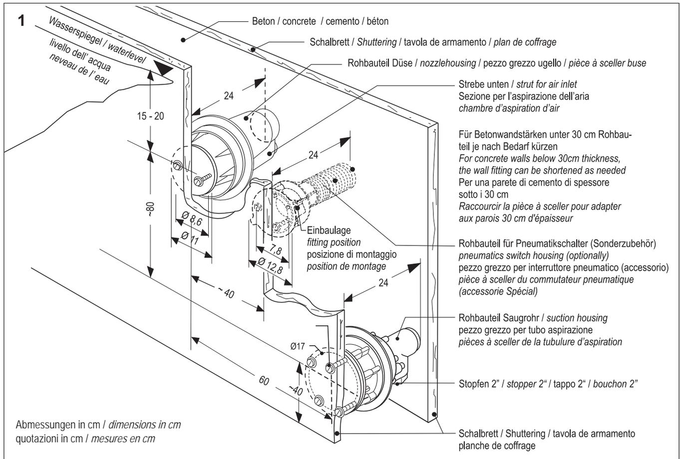
Haben Sie ein Düsen-Rohbauteil eingebaut, schliessen sich alle weiteren (3 bis 5 Stück) in einem waagrechten Abstand von ca. 1,5 m oder in gerader Linie fallend bis zu einem Bodenabstand von 60 cm an.
