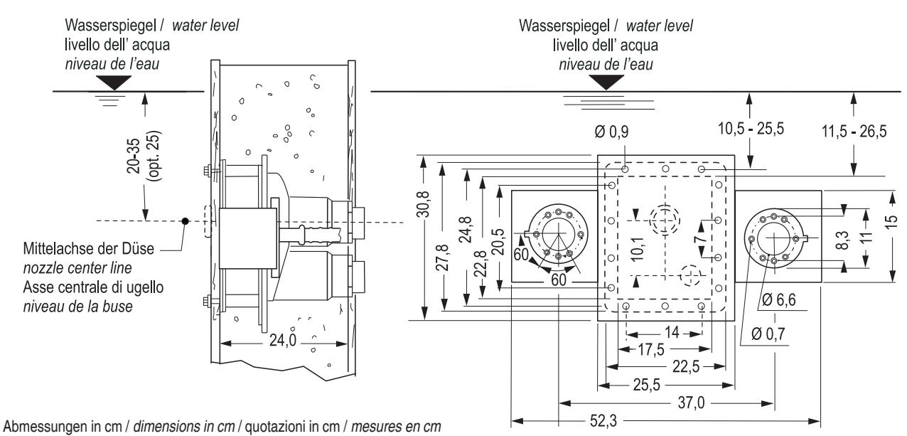
**Einbau des Düsenmantelgehäuses
