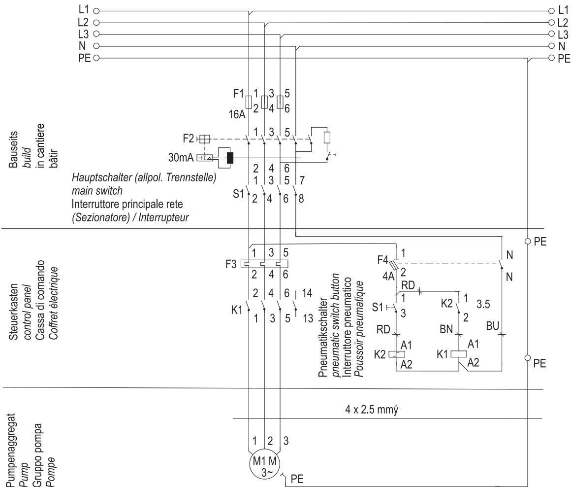
Sicherung F1 Schalter 30 mA, Hauptschalter sind bauseits nach den gültigen DIN VDE Bestimmungen anzuordnen
