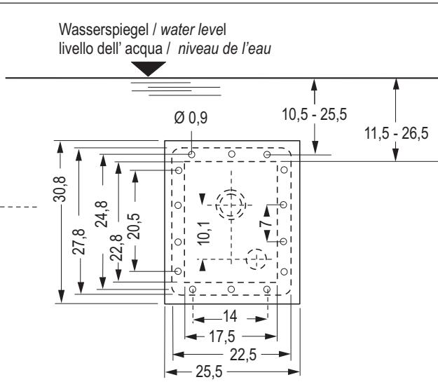
Einbau des Düsenmantelgehäuses
