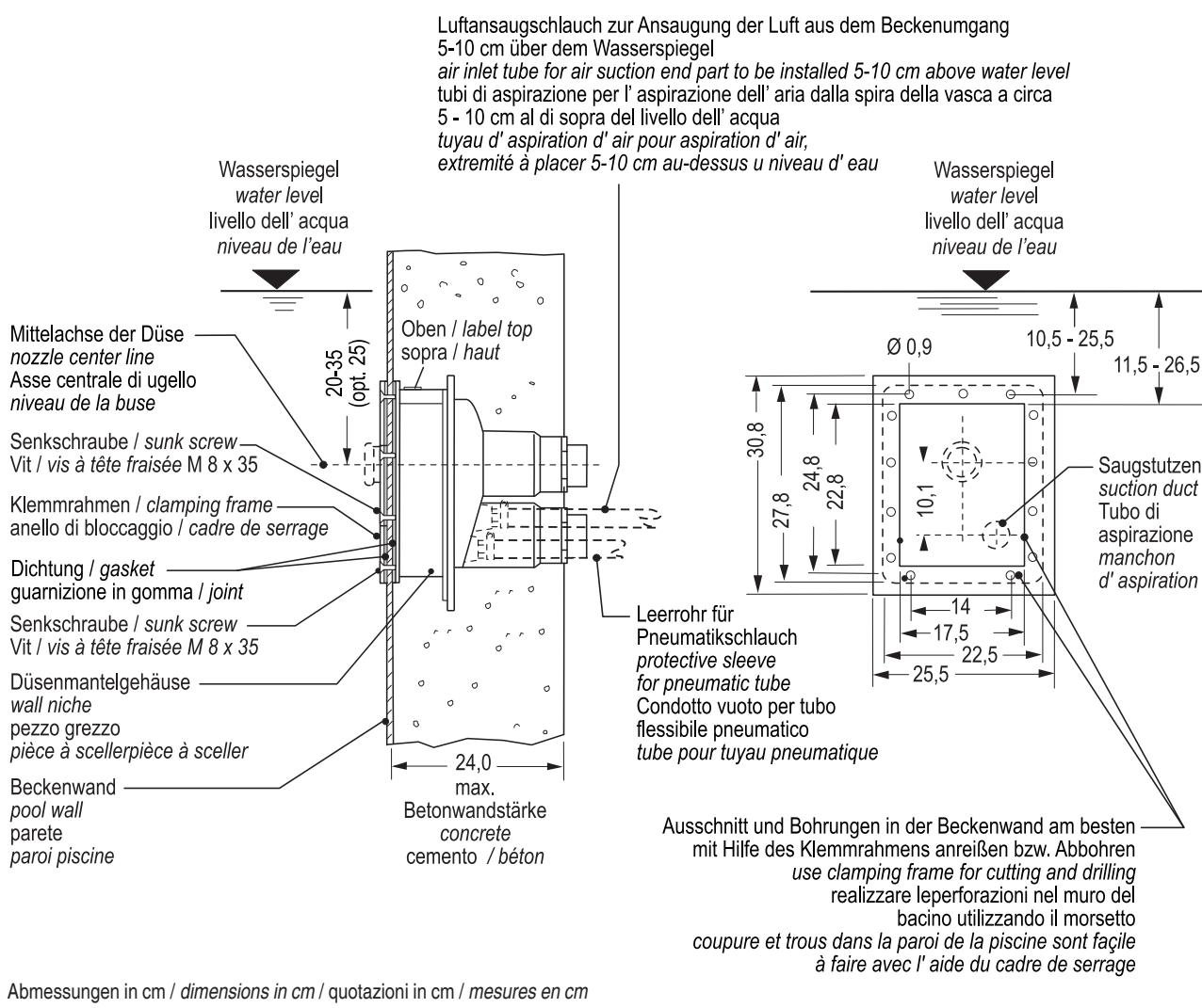
Einbau des Düsenmantelgehäuses mit Beleuchtung in die Schalung (Bild 6)
