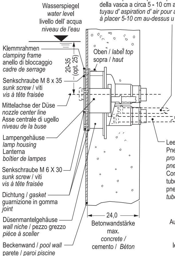
Luftansaugschlauch zur Ansaugung der Luft aus dem Beckenumgang 5-10 cm über dem Wasserspiegel
