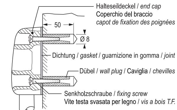
Bei Fertigbecken müssen die beiden zusätzlichen Bohrungen angezeichnet werden
