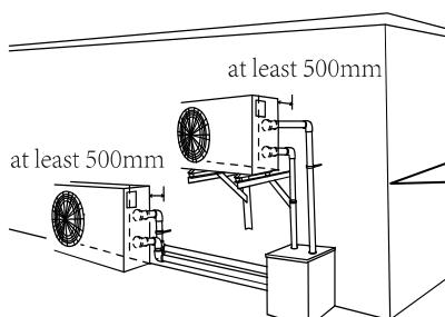
*Соединение должно быть выполнено с помощью жесткой трубы!*
