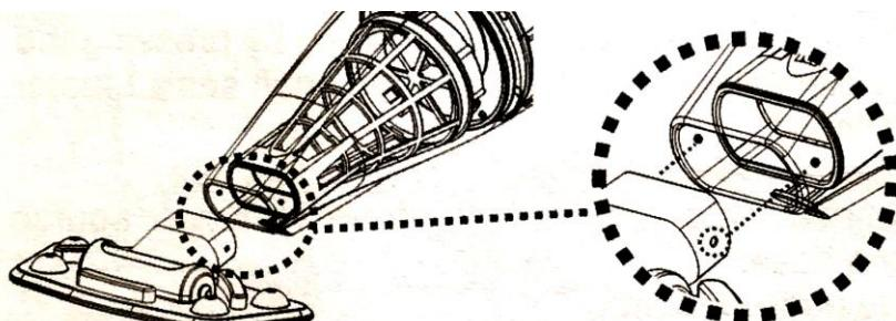
**ПРИМЕЧАНИЕ:** для замены щетки на всасывающей насадке, поднимите один конец щетки и вытащите ее, чтобы освободить место для новой.
