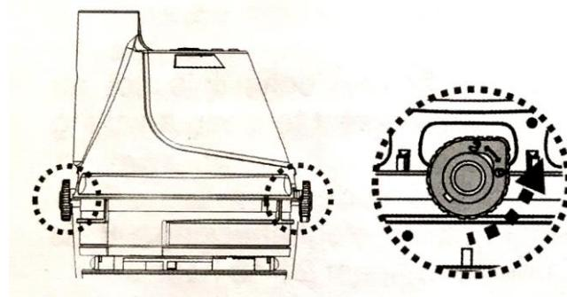
2. Установите задний корпус на плоскую поверхность (вверх дном, кнопка ВКЛ/ВЫКЛ питания направлена вверх). Совместите и сдвиньте защелку зарядного устройства в боковой паз на нижней поверхности заднего корпуса, пока защелка не зафиксируется. Убедитесь, что контактные пластины контактируют надлежащим образом. Подключите гнездо наружного переходника к зарядному устройству на торце зарядного устройства.
