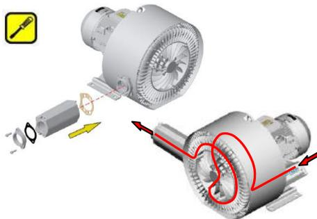
Выпускной глушитель для двухступенчатых компрессоров (тип компрессора №3) поставляется отдельно и должен быть установлен до запуска. Не снимайте установленные на заводе металлические крышки!
