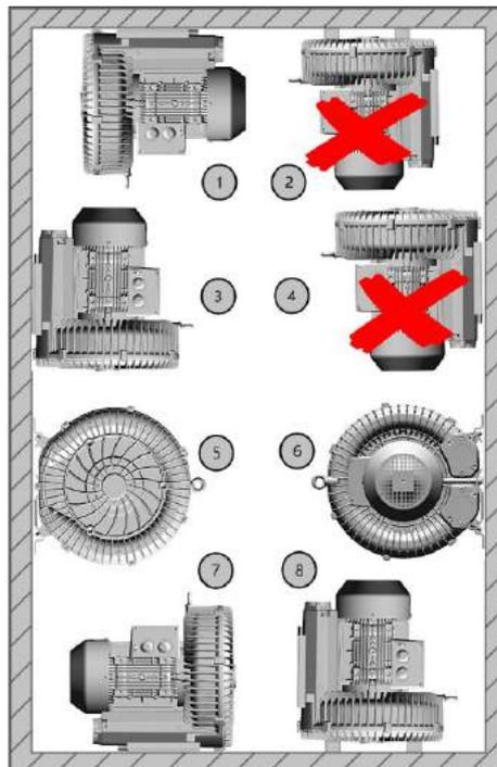
Используйте уже существующую схему отверстий, чтобы закрепить компрессор на месте установки. Для обеспечения достаточного охлаждения необходимо учитывать зазор между машиной и окружающими стенами. Машина не должна быть полностью закрыта. Убедитесь, что место установки проветривается, чтобы обеспечить достаточное охлаждение компрессора.
