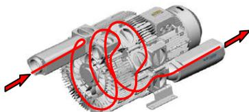
Впускной глушитель для двухступенчатых и трехступенчатых воздуходувок (компрессор 5 и 6) поставляется отдельно и должен быть установлен перед запуском. Не снимайте установленные на заводе металлические крышки!
