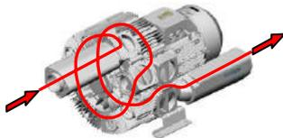
6. ASP...-3S...- трехступенчатый, 3 крыльчатки-последов.
