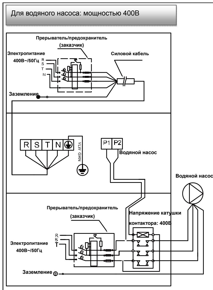
Параллельное соединение с таймером фильтрации
