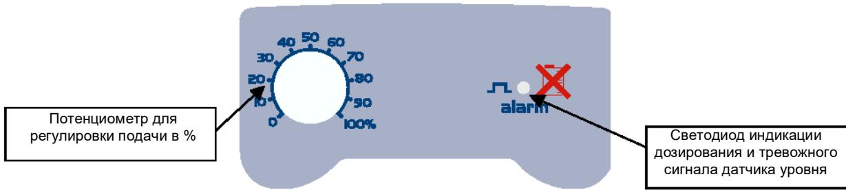
Насос производит дозирование в процентном соотношении, выбранном потенциометром вручную.
