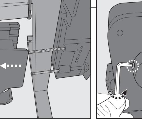
Отсоединение моторизованного блока Открутите 4 винта-бабочки и снимите все шайбы и винты с задней панели. Снимите заднюю панель с моторизованного блока.
