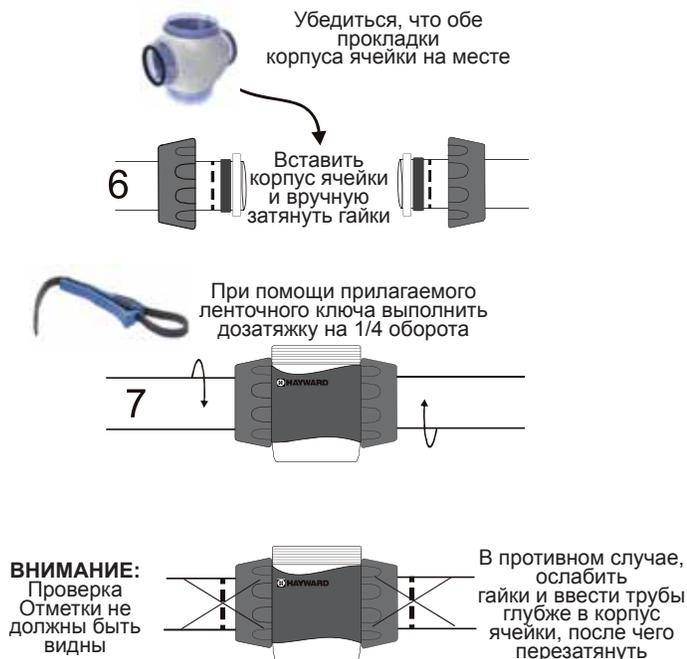
Снять с ячейки пенопластовый уплотнитель. Перед установкой ячейки внутрь корпуса убедиться, что уплотнительные кольца закреплены. Нанесите немного смазки на разъемах.
