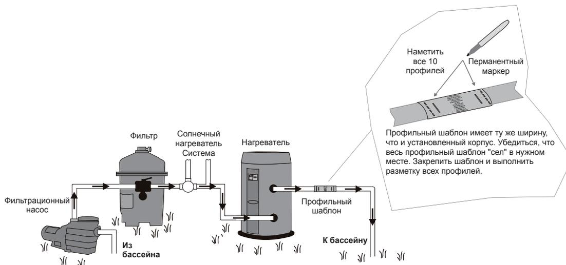
Снять шаблон, срезать трубу и установить комплект гаек, как показано ниже. Установить комплект гаек с каждой стороны срезанной трубы (резьбой внутрь). Проверьте правильность установки гайки, уплотнительного кольца и шайбы на трубу, как показано на схеме (N°1).
