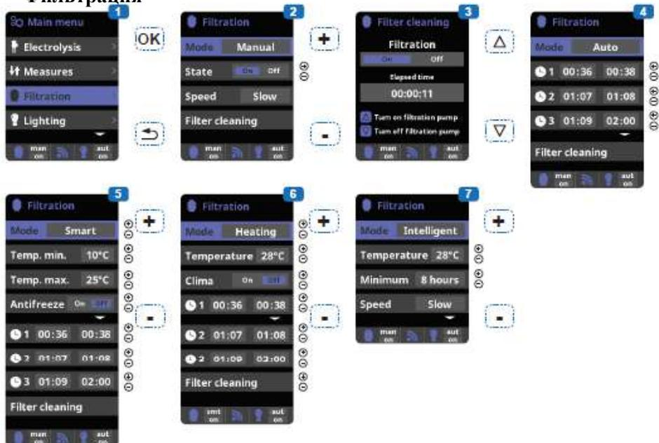
**6 Подогрев (опция доступна с датчиком температуры)\*:** Этот режим работает так же, как и автоматический режим, но он также может выполняться с помощью реле, которое управляет температурой. Уставка температуры определяется в этом меню, и система работает с гистерезисом на один градус (например, если заданная уставка температуры составляет 23 °C, система начнет работать, когда температура опустится ниже 22 °C и выключится только тогда, когда температура поднимется выше 23 °C).
