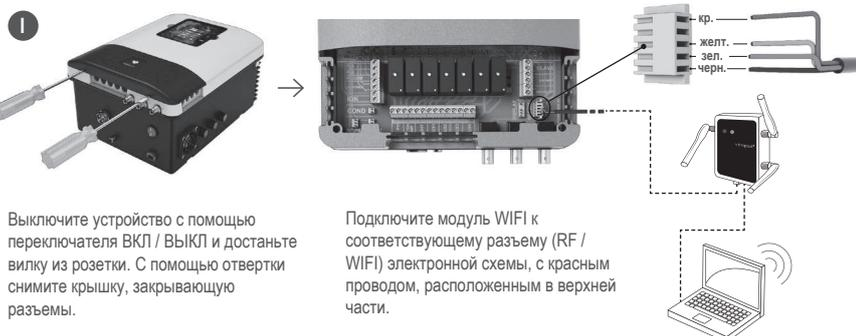
Выключите устройство с помощью переключателя ВКЛ / ВЫКЛ и достаньте вилку из розетки. С помощью отвертки снимите крышку, закрывающую разъемы.
