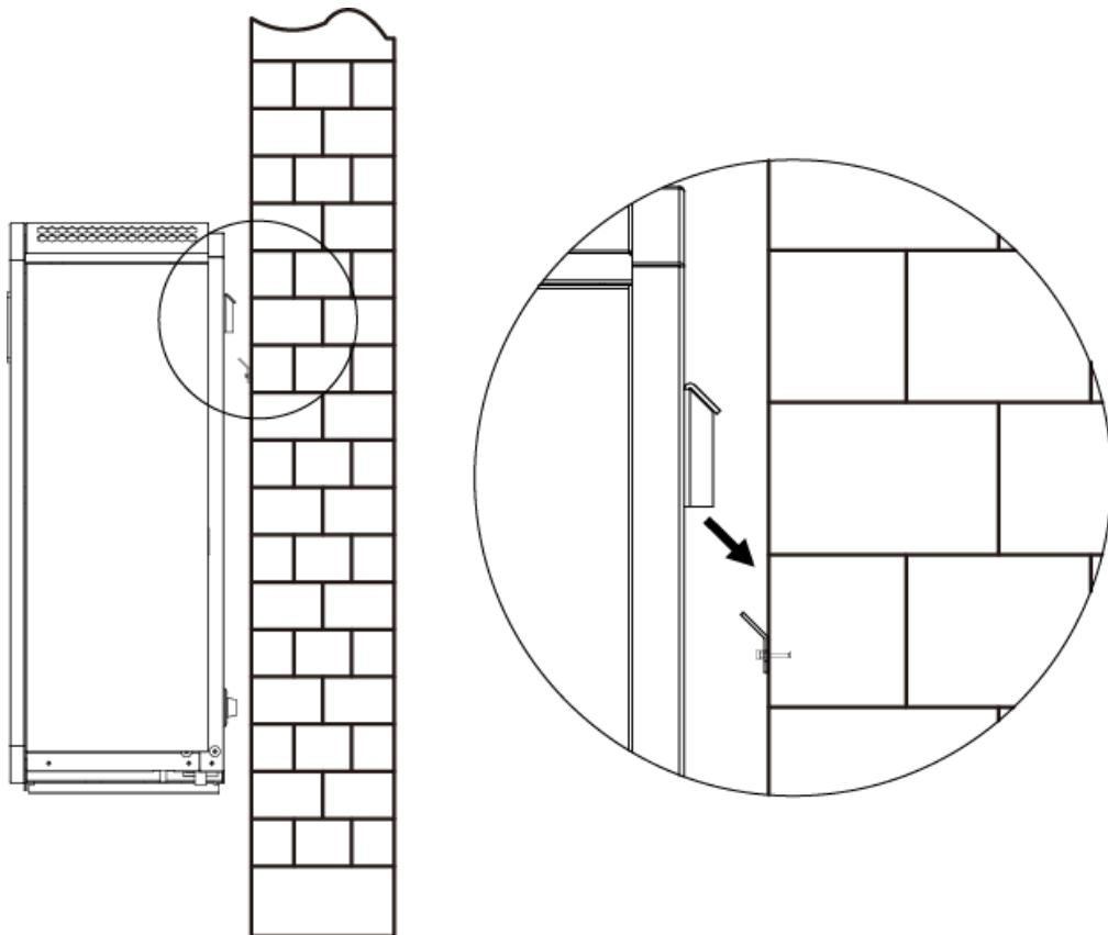
**Подвесив оборудование на кронштейн осторожно опускайте его до тех пор, пока накладки снизу не упрются в стену.**
