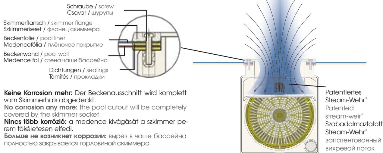
**Keine Korrosion mehr:** Der Beckenausschnitt wird komplett vom Skimmerhals abgedeckt.
