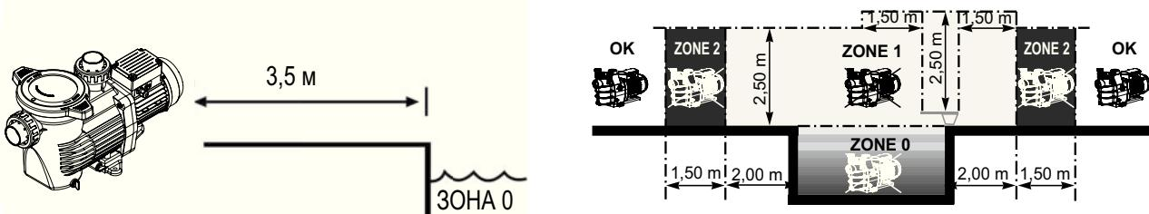
Установите насос в проветриваемом сухом месте. Для естественной вентиляции двигателя необходимо обеспечить свободную циркуляцию воздуха вокруг него. Необходимо периодически проверять, что охлаждению двигателя не препятствуют какие-либо объекты, листья и прочие предметы.
