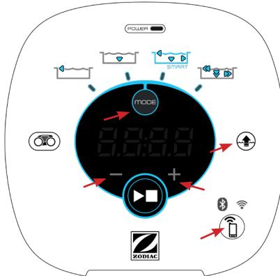
Пример блока управления с кнопками, подлежащими проверке (кнопки отличаются в зависимости от модели)
