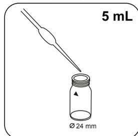
Наполните кювету 24 мм полностью деминерализованной воды 5.
