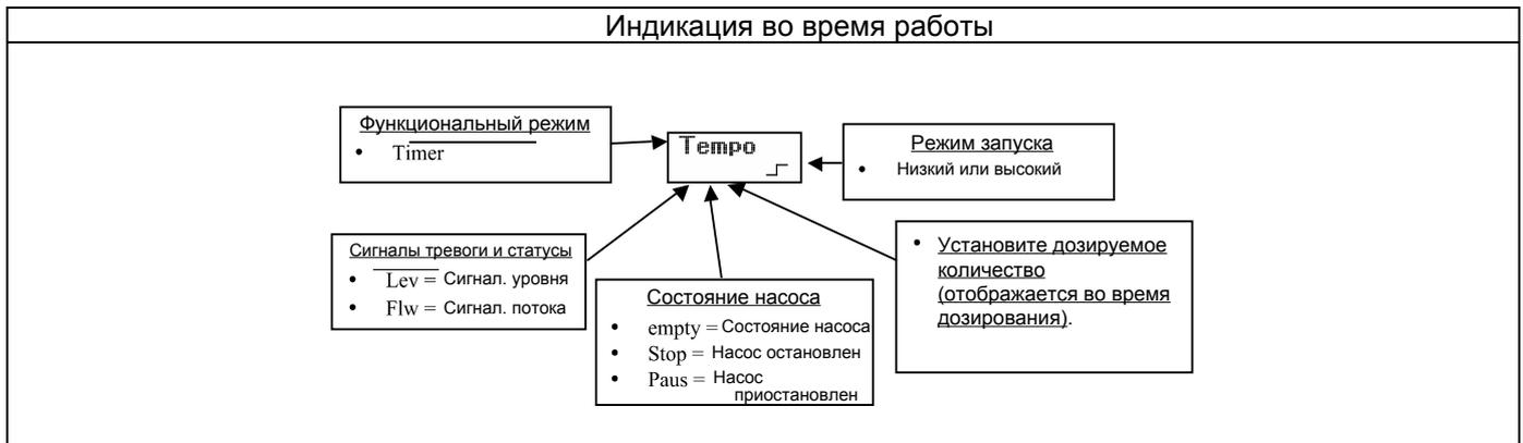
**Пункт 8 - Дозировка по времени (вход частотного сигнала «TRIGGER» не активирован)**
