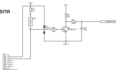
Схема подключения частотного входа с сигналом напряжения
