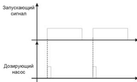
**В. Циклическое дозирование: насос работает постоянным циклом пока присутствует запускающий сигнал.**
