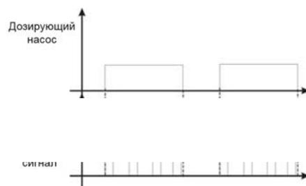
**3) Режим программирования (переключатель в положении OFF/Stand-by) «Насос остановлен»**
