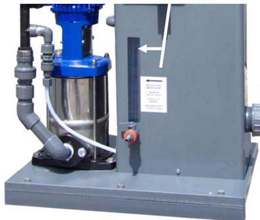
Засыпьте активированный уголь перед вводом установки в эксплуатацию до максимальной отметки. Емкость вмещает ок.3,2 кг активированного угля.
