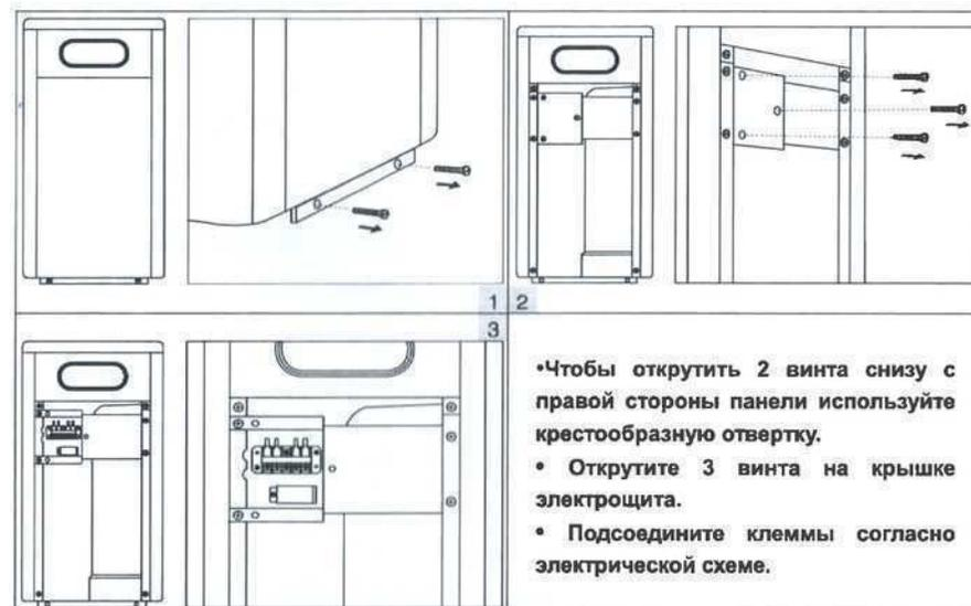
Примечание: для подключения питания модели IPH28/35 необходимо открыть заднюю панель. Производить процедуру подключения согласно указанному выше.
