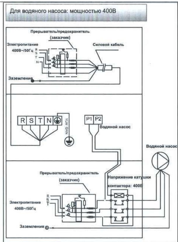
Параллельное соединение с таймером фильтрации
