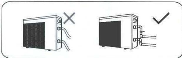
2.1.2. Для обеспечения гарантированной тепловой производительности длина водопровода должна составлять  $\leq 10$  м между бассейном и тепловым насосом.
