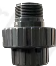
На малюнку: Муфта із зовнішнім різьбленням PN16. G=6/4" D=50mm
