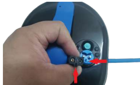
4.6 Перш ніж вставляти шнур зарядки в акумулятор, зверніть увагу на виїмку на гнізді, яка відповідає слоту на зарядному шнурі. Вилка НЕ призначена для нахилу.
