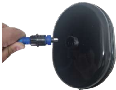
4.1 Візьміть шнур живлення робота і підключіть його до акумулятора.
