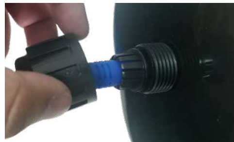
4.3 Візьміть чорний ковпачок шнура живлення і прикрутіть його на акумулятор.
