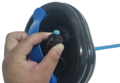
4.5 Відкрутіть кришку роз'єму зарядки на верхній частині акумулятора.
