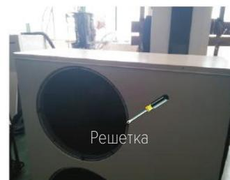
В. Гаечным ключом отвинтите шурупы и выньте вентилятор (рис. 3, 4)
