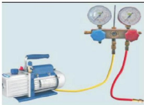
3. Подготовьте вакуумный насос и манометр. Подключите одну сторону трубки манометра к вакуумному насосу.
