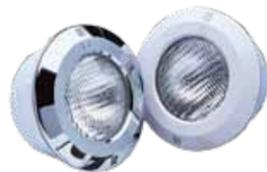
Поставляются с нишей для установки в стену бассейна. Изготовлены из полистирола. Галогенная лампа PAR 56 300 Вт – 12 В. Ниша дает возможность укладки кабеля через боковую сторону или сзади; резьба M25. Стандартный светильник поставляется без трансформатора.
