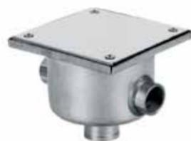
Из нержавеющей стали AISI-316. Два боковых выхода с резьбой PG 16 с переходником PG-16-M25, резьбовой донный выход 3/4" BSP.
