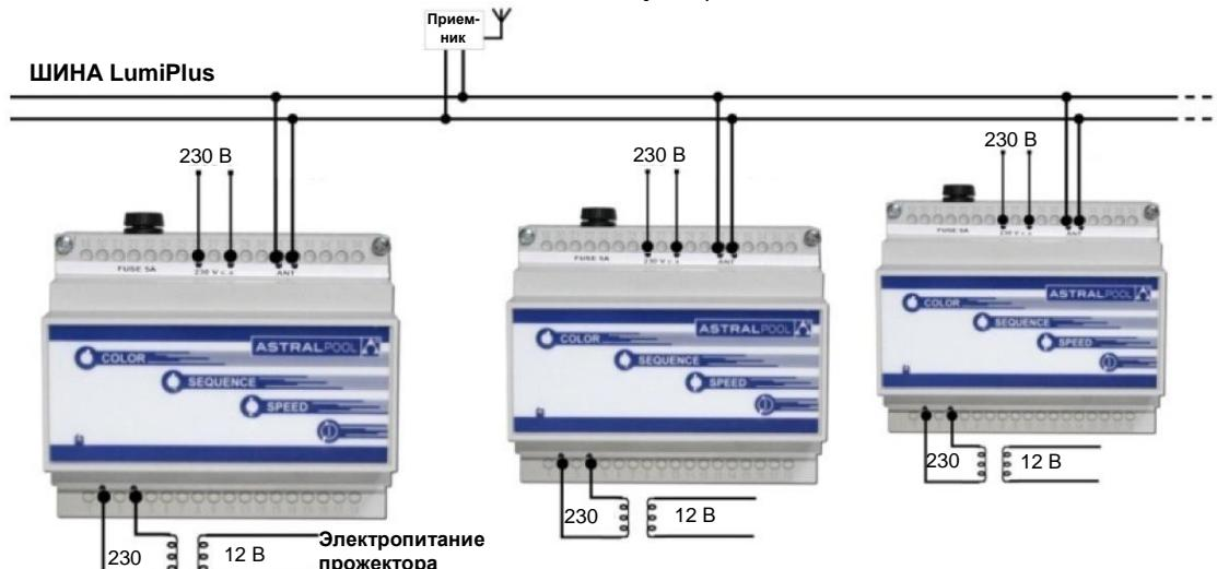
Система может осуществлять синхронизацию до 10 модуляторов, и можно смонтировать максимум 3 антены в одной установке, чтобы гарантировать максимальное перекрытие.
