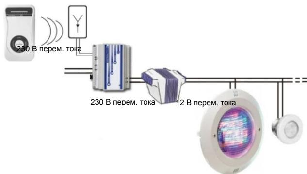
Схема для прожекторов LumiPlus PAR56; Jelly; Flat, Standard и Mini.
