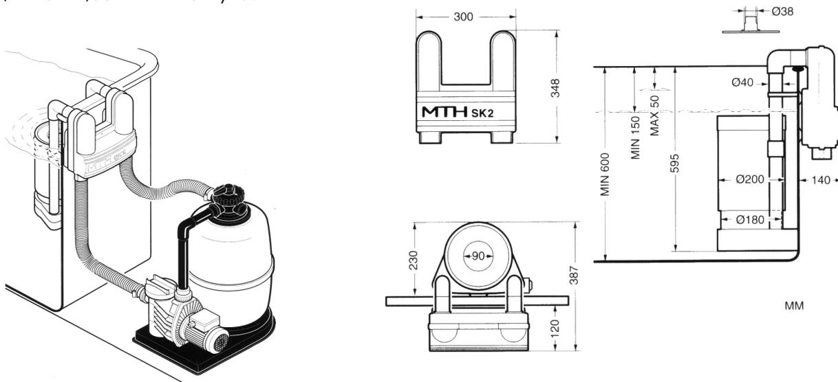
Тип № 050.030 - Водозаборная установка для сборных бассейнов
