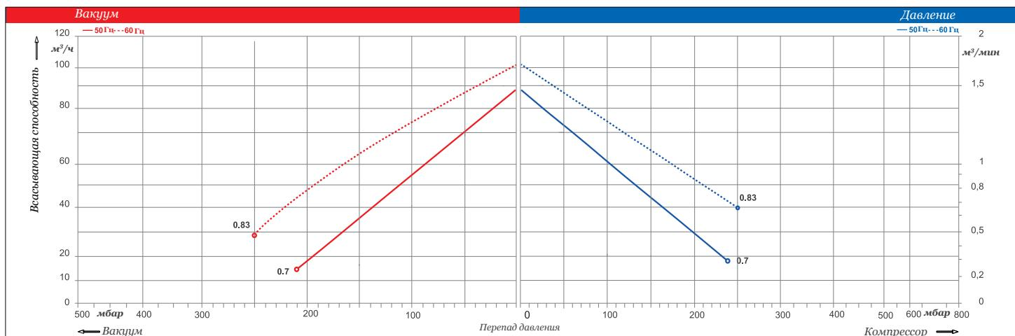
Caudal de admisión atmosférica de 1013 (mbar abs.) y Tº 15ºC. Tol. +/- 10% / Airflow at inlet and 1013 (mbar abs.) and Temp. 15ºC. Tol. +/- 10% / Расход воздуха на входе 1013 (мбар abs.) и Темп. 15ºC +/- 10 %
