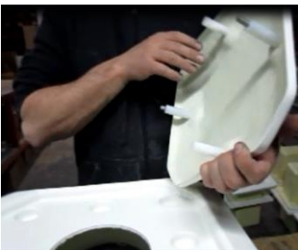
5. Posicione la tapa sobre el marco | Place the lid on the frame
