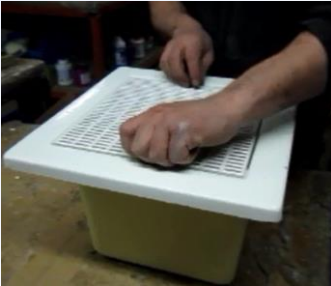
1. Quite los tornillos de la rejilla | Remove grid screws
