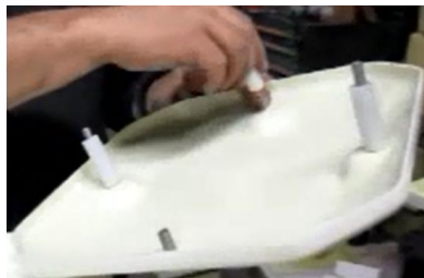
4. Posicione tornillos y separadores. Unos tornillos (largos) se enroscan en el sumidero, otros (cortos) apoyan con el casquillo ciego | Place the screws. A part (the long ones) will fix the lid to the drain, other part (the short ones) will be only screwed into the nylon cup.
