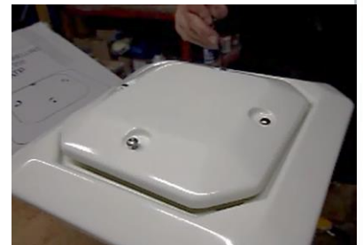
4. Posicione tornillos y separadores. Unos tornillos (largos) se enroscan en el sumidero, otros (cortos) apoyan con el casquillo ciego | Place the screws. A part (the long ones) will fix the lid to the drain, other part (the short ones) will be only screwed into the nylon cup.
