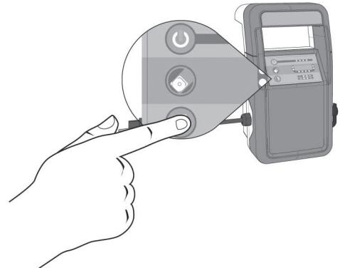
9. Il pulitore automatico avvia automaticamente il ciclo di pulizia selezionato se nessun pulsante dell'alimentatore viene premuto per 10 secondi. Gli indicatori di potenza, le spie della modalità di pulizia e la spia del programma selezionato si accendono in modo continuo durante il ciclo di pulizia.
