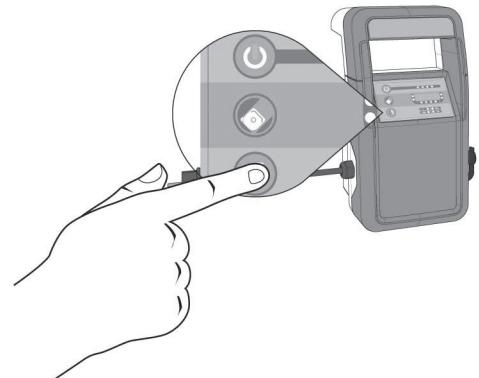
9. La limpiadora automática iniciará automáticamente el ciclo de limpieza seleccionado cuando no se haya presionado ningún botón en la fuente de alimentación durante 10 segundos. Los indicadores de alimentación, los indicadores de modo de ciclo de limpieza seleccionados, y el indicador de programa de limpieza seleccionado se encenderán sin interrupción durante el ciclo de limpieza.
