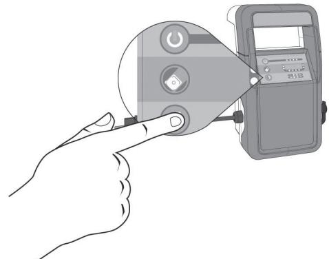
9. De robottreiniger start de geselecteerde reinigingscyclus automatisch op wanneer er gedurende 10 seconden geen knoppen op de stroombron werden ingedrukt. De stroomindicatoren, de indicatoren van de geselecteerde reinigingscyclusstand en de indicator van het geselecteerde reinigingsschema zullen continu branden tijdens de reinigingscyclus.
