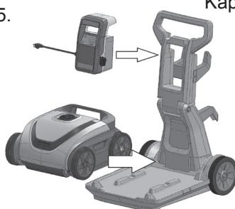
Den Reiniger und das Netzteil montieren
