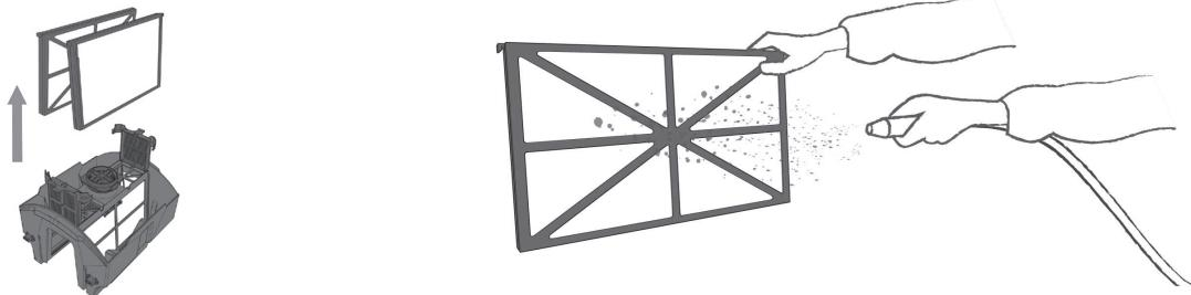
c. Falls die Filterelemente durch Öle blockiert wird, können Sie bei Ihrem Hayward-Händler einen Beckenreiniger für die Filterelemente kaufen.
