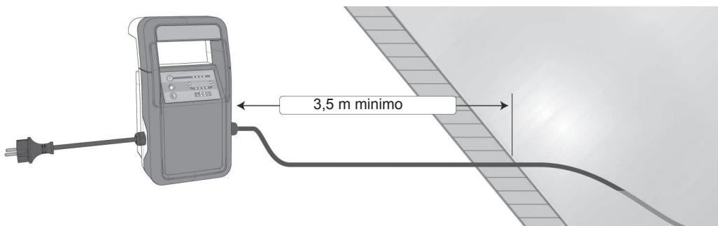
3. Srotolare il cavo galleggiante lungo il bordo della piscina per rimuovere eventuali aggrovigliamenti dovuti all'immagazzinamento del cavo e valutare la misura approssimativa del cavo pulente necessario.
