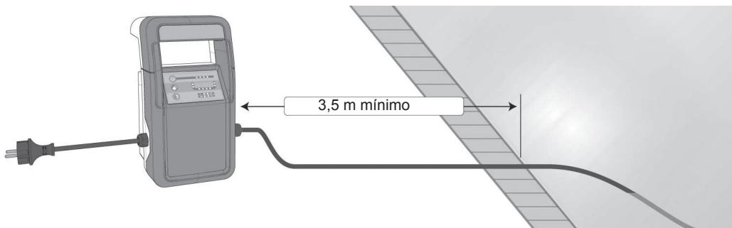
3. Extienda el cable flotante por el borde de la piscina al sol para eliminar cualquier enredo que el cable tuviese debido al almacenamiento y mida la cantidad aproximada de cable de la limpiadora necesario para la cobertura de la piscina.
