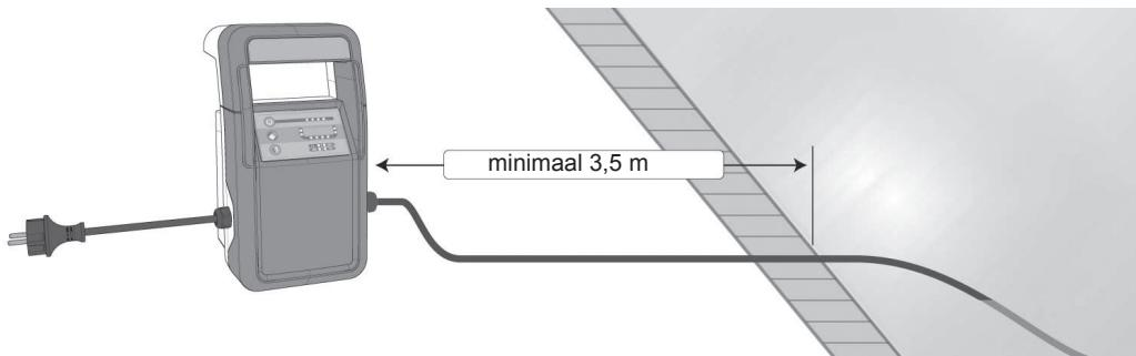
3. Leg de losse kabel in dezon uit over de badrand om kronkelingen van het snoer van bij de opslag eruit te krijgen en meet het bij benadering benodigde reinigerssnoer.
