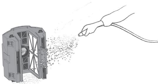
4. Filterpatronen moeten niet worden verwijderd voor de reiniging.
