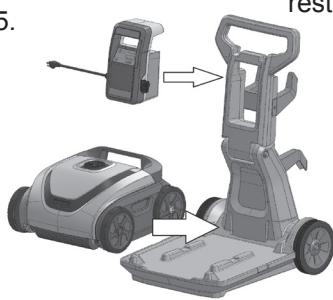
Installer le robot & le boîtier d'alimentation
