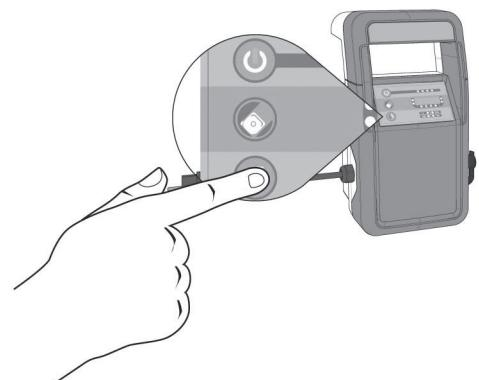
9. Le robot lancera automatiquement le cycle de nettoyage choisi si aucune touche du boîtier n'a été enfoncée pendant 10 secondes. Les témoins de marche, les témoins des modes de cycles de nettoyage et le témoin de programmation de nettoyage choisis s'allument en continu pendant l'exécution du cycle de nettoyage.
