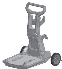
Kunststoffkappen von der Achse entfernen. Transportwagen auf die Seite legen, ein Rad auf die Achse schieben. Mit der Verwendung eines Hammers die Achsenkappe vorsichtig auf die Achse klopfen. Transportwagen umdrehen und das übrige Rad samt Kappe installieren.
