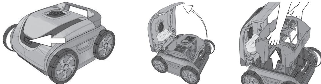
3. Kantel de bak om het puin te verwijderen en spoel hem af met een tuinslang om kleine afvaldeeltjes te verwijderen.
