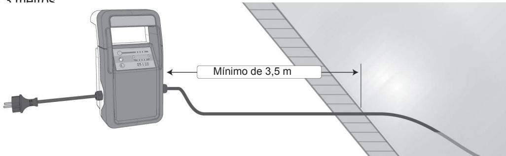
3. Estique o cabo flutuante junto ao pavimento da piscina ao sol para eliminar quaisquer torções que o cabo possa ter adquirido durante o armazenamento e meça a quantidade aproximada de cabo do aspirador necessária para a cobertura da piscina.
