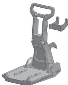
Oberen Haken durch die Verwendung von 2 Schneidschrauben anbringen.
