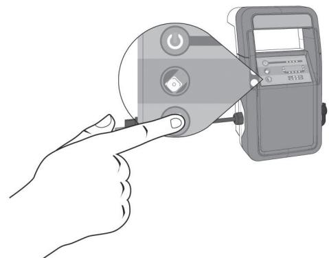
9. O robô aspirador iniciará automaticamente o ciclo de limpeza selecionado quando nenhum botão da fonte de alimentação for pressionado durante um período de 10 segundos. Os indicadores de energia, os indicadores do ciclo de limpeza selecionado e o indicador do programa de limpeza selecionado irão acender-se em contínuo durante o ciclo de limpeza.
