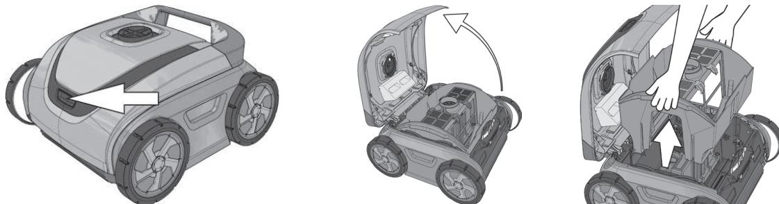
3. Renverser le bloc filtrant pour retirer les débris et rincer avec un tuyau d'arrosage pour éliminer les petites particules.
