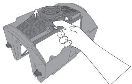
b. Выньте фильтрующие картриджи. Садовым шлангом с распылительной насадкой промойте компоненты фильтров, чтобы удалить мусор. Держите компоненты фильтров, как показано на рисунке, чтобы из них выпадал мусор. Чем чище фильтр, тем более эффективным будет процесс очистки.
