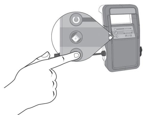
9. Der Roboterreiniger wird den ausgewählten Reinigungszyklus automatisch beginnen, sobald für 10 Sekunden keine Tasten auf der Stromversorgung betätigt werden. Die Leistungsanzeigen, die Anzeige für den ausgewählten Reinigungszyklus-Modus und die Anzeige für den ausgewählten Reinigungsplan werden während dem Reinigungszyklus durchgehend leuchten.
