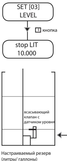
Данная функция определяет статус предварительного извещения пользователя о скором завершении дозируемого вещества. Устанавливаемая величина резерва должна определяться, исходя из объема вещества, остающегося между всасывающим клапаном и уровнем всасывания насоса.
