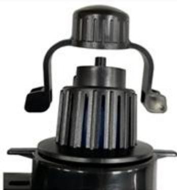
Снимите зажим держателя лампы с жесткого колпачка.
