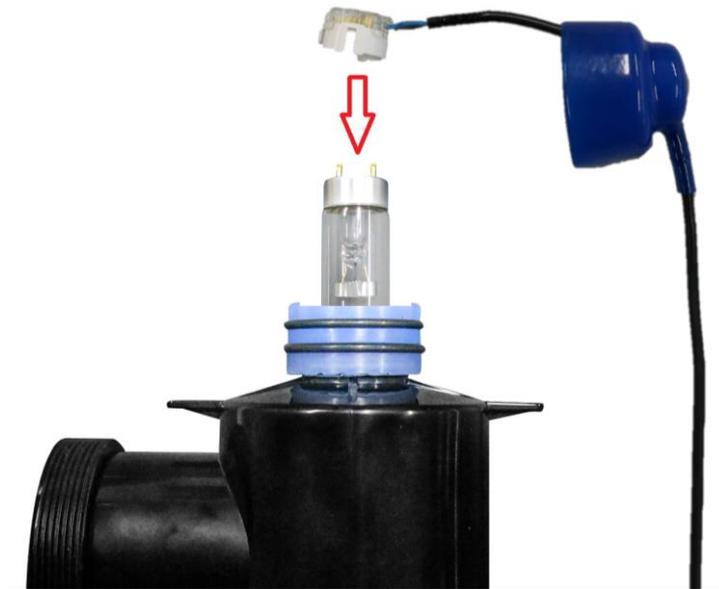
**ПРИМЕЧАНИЕ.** При сборке изделия сдавите синий кожух патрона лампы, чтобы вытеснить из-под него воздух. Если оставить воздух внутри, патрон может отсоединиться от лампы. **Прежде чем возобновлять подачу электроэнергии, включите подачу воды и осмотрите изделие на предмет утечек.**
