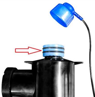
Выкрутите синюю стопорную гайку кварцевой трубки против часовой стрелки. Прежде чем трубку можно будет извлечь, необходимо освободить ее с обоих концов.
