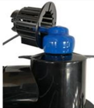
Снимите жесткий колпачок с синего патрона лампы.
