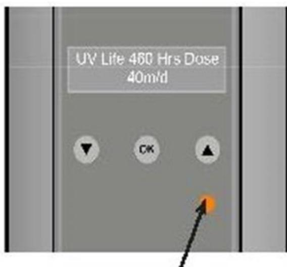
При каждом включении ультрафиолетовой лампы таймер начинает обратный отчет времени (исходная точка: 9 000 часов), и на экране отображается остаточный ресурс ультрафиолетовой лампы.
